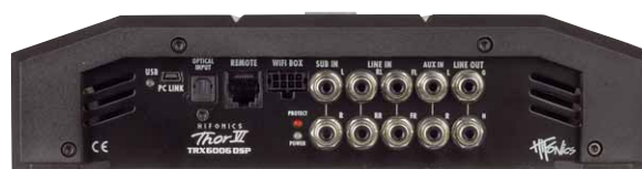
Überzählige DSP-Kanäle werden als prozessierte Cinch-Ausgänge herausgeführt
