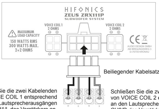
Schließen Sie die zwei Kabelenden von VOICE COIL 1 entsprechend an den Lautsprecherausgängen CH1/L des Verstärkers an.
