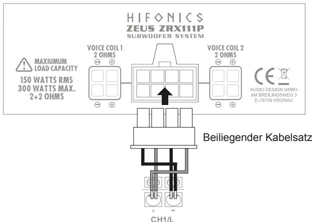
Schließen Sie die vier Kabelenden entsprechend an den Lautsprecherausgängen des Verstärkers an.
