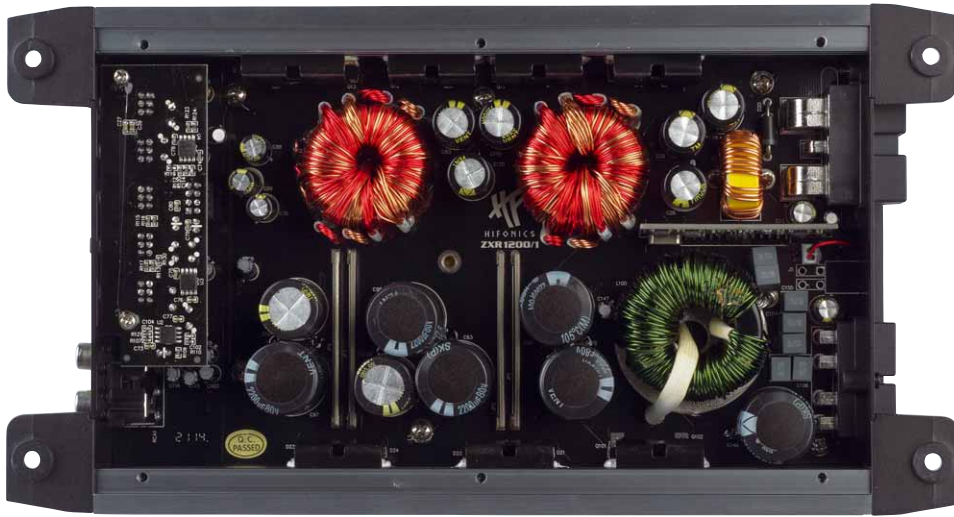
Doppelnetzteil, satte Pufferung und eine riesige Filterspule der Class-D Schaltung
